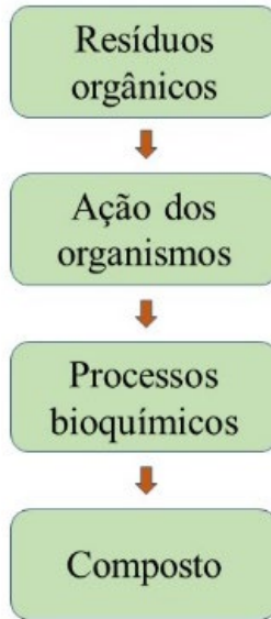
Figura 2. Esquema simplificado do processo de compostagem.
